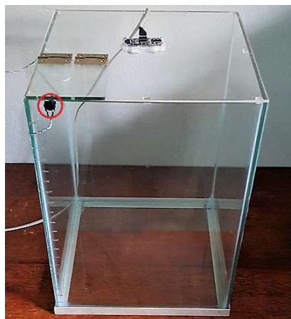
FIGURA 12 – Reservatório com fim de curso e tampa em acrílico
